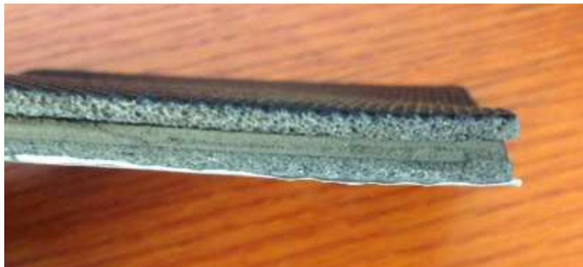
**\*\*\* DEVIAZIONE DALLA NORMA DI TIPO DIMENSIONALE.** Le dimensioni adottate sono differenti da quelle richieste per i piccoli elementi, per insufficiente larghezza del campione.
